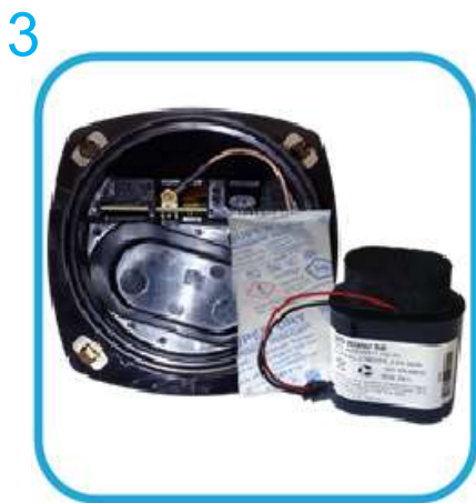
Eliminar la batería vieja y la bolsa desecante
